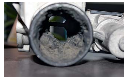
Beispiel für eine verkockte Drosselklappe und Überzeugungsgrund genug, aktiv zu werden.
